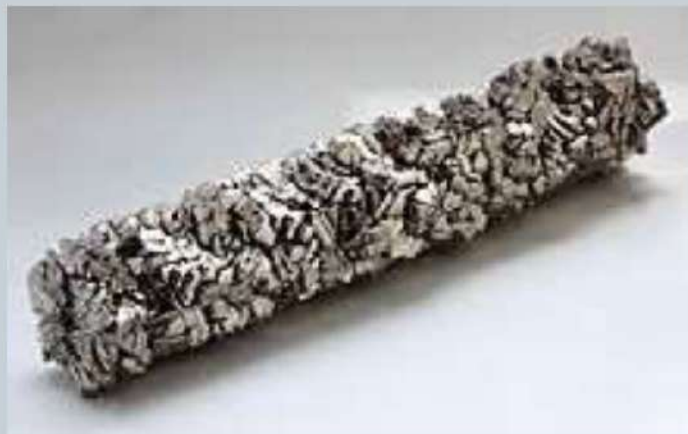
O bară de cristal de titan produsă prin reacție cu iodul
