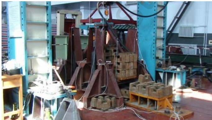
Fig.4.72 Dispozitiv experimental pentru controlul vibrației motorului Diesel
