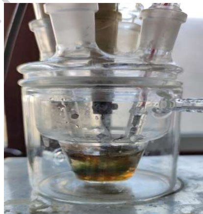
Fig. 4. Celula de lucru cu cei trei electrozi si probă supusă testului.
