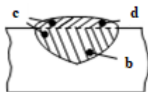
Fig. 3.1. Reprezentarea grafică a secțiunii cusăturii pentru definirea coeficienților de participare
