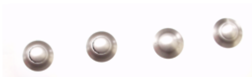
Figura 5.3. Epruvetă supuse încercării de ambutisare la rece prin metoda ERICHSEN
