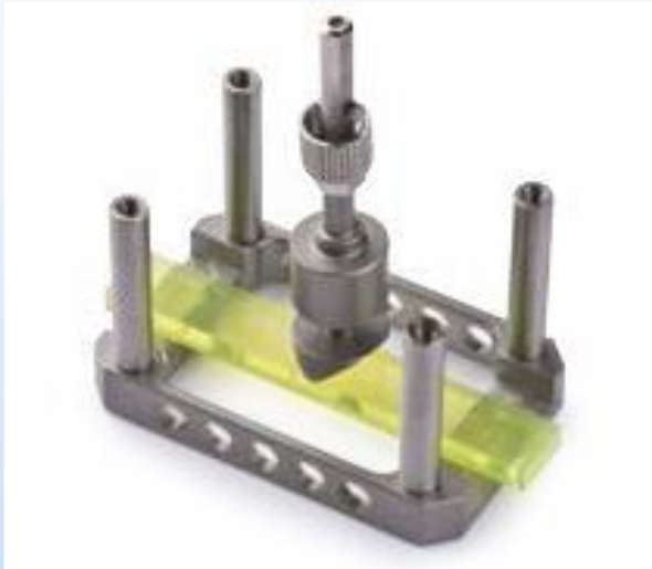
Suport probă pentru încovoiere în trei puncte
