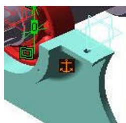
Fig.15. Fixarea componentului **corp reductor**
