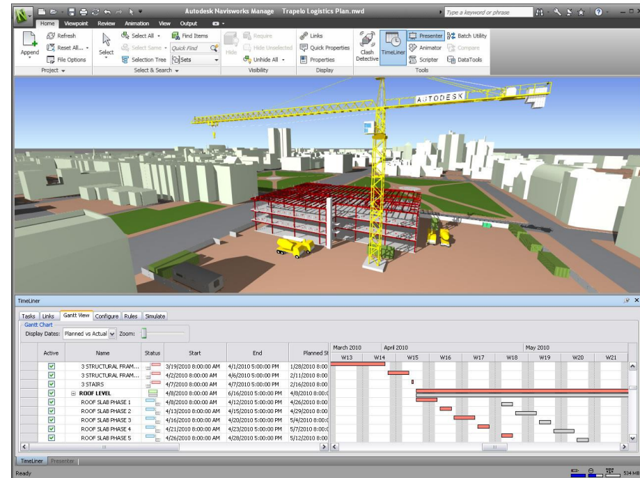
Fig. 2. BIM – Crearea unui plan logistic de construcție
