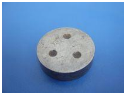
Figura 5. Epruvetă din oțel supusă încercării de duritate Brinell; 1 – epruvetă, 2 – urma penetratorului.
