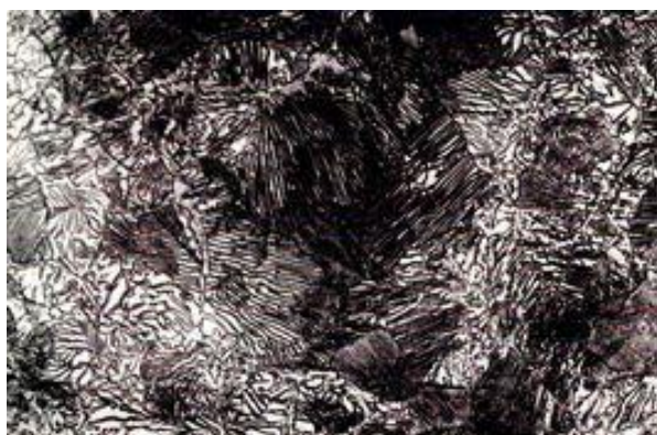
Figura 12. Amestecuri mecanice: eutectic (a, 500:1) și eutectoid (b, 500:1), /6/.
