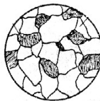
Figura 2. Microstructura oțelului OT400 după: a – turnare (dendritică neomogenă); b-recoacere de omogenizare (grăunți cristalini de perlită – negri și ferită alfa – albi); 500:1.
