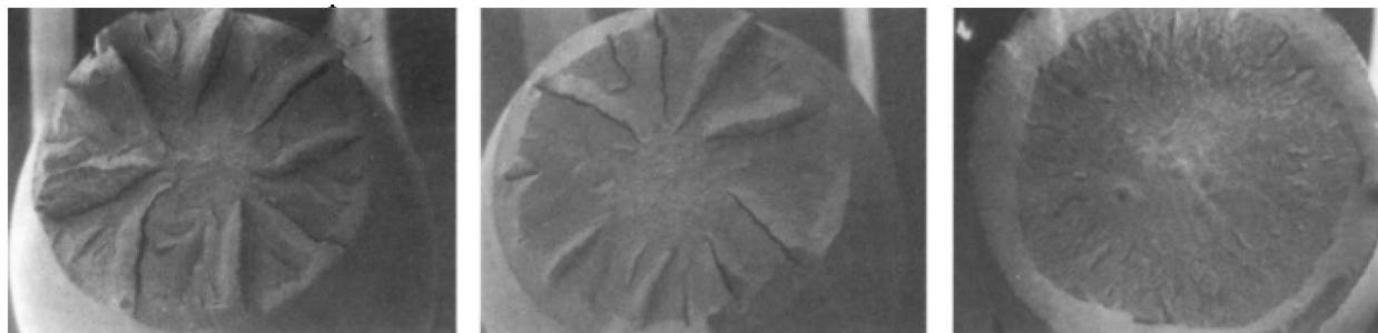
Figura 3. Urme radiale pe suprafața de rupere a unei epruvete supuse la încercarea la tracțiune, executate din oțel SAE 4150 (călit și revenit în diferite condiții de tratament termic) /19/
