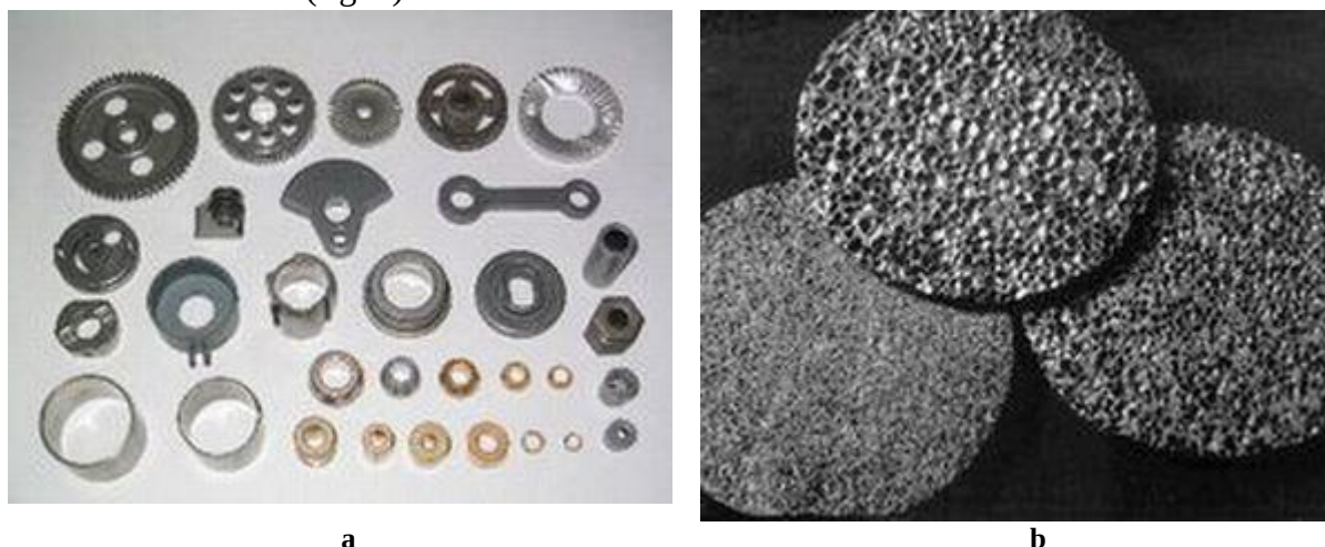
Figura 3. Piese obținute prin sinterizare; a – materiale cu proprietăți de frecare impuse și piese de rezistență pe bază de oțeluri și aliaje de cupru, b – filtre din oțel.
