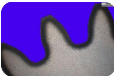
Figura 6. Carburarea uniformă a suprafeței unei roți dințate /17/
