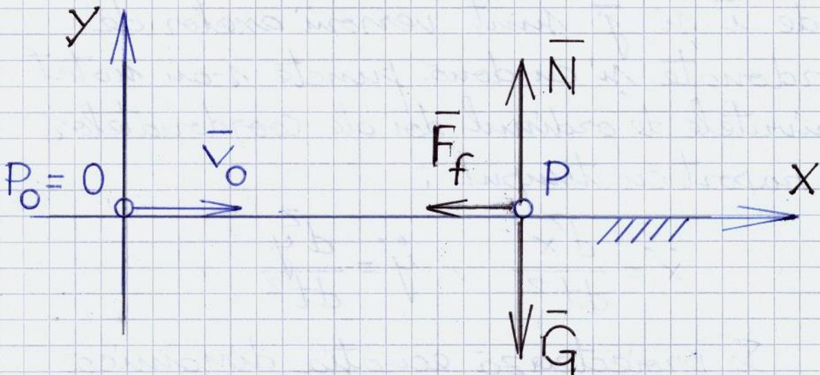
Se scrie ecuația dinamicii punctului material, adică masa înmulțită cu accelerația este egală cu suma forțelor care acționează asupra acestuia, ecuație vectorială:
